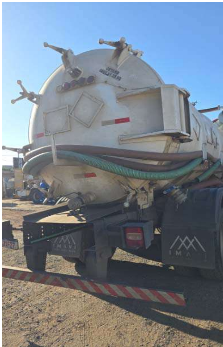
Figura 2 "Sistema de alta pressão do caminhão sewer-jet, com bomba e mangueiras apropriadas para execução de serviços de limpeza de redes de esgoto, atendendo às especificações técnicas do edital."
